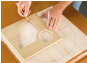
Odrysuj kształt na materiale roboczym, wykorzystując szablony zawarte w zestawie.
