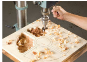
Używając wiertarki pionowej, wstępnie wyfrezuj kształt odrysowany od szablonu.
